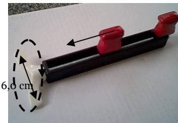
Figuur 8 – Een vorkexpander wordt gebruikt om de achtervork van een fiets uit elkaar te duwen. Door het draaien van de witte vleugelmoer beweegt het contactblokje naar voren.
