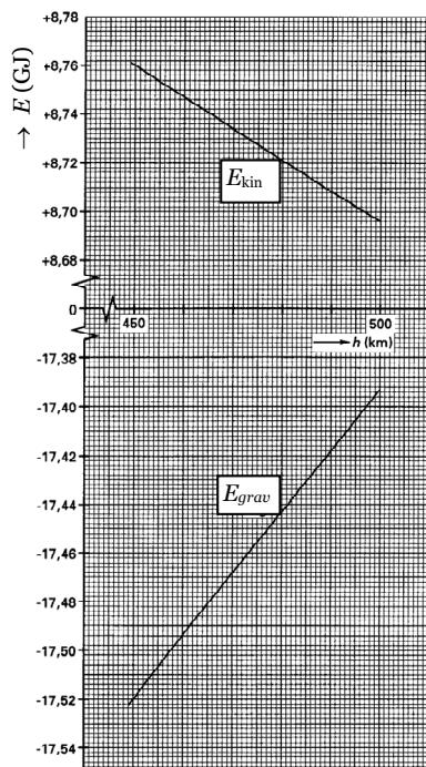
Figuur 4 – Gravitatie-energie en bewegingsenergie van een satelliet.
