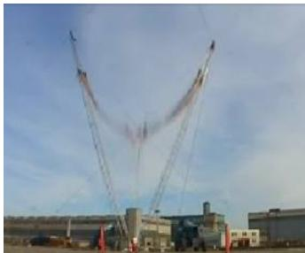
Figuur 3 – Op deze foto is te zien dat de rubber elastieken al na een korte afstand niet meer gespannen zijn. De pop bereikt al snel de maximale snelheid.
