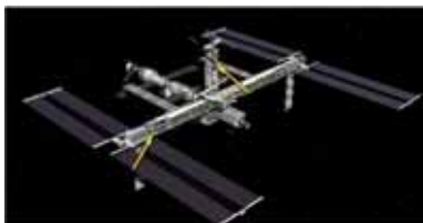
Figuur 35 – Het International Space Station ISS. Dit ruimtestation bevindt zich op een hoogte van ongeveer 342 km boven het aardoppervlak en beweegt met een snelheid van 7,69 km/s.
