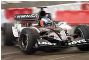
Figuur 37 – Bij een racewagen zorgt de spoiler ('vleugel') voor een grotere normaalkracht.
