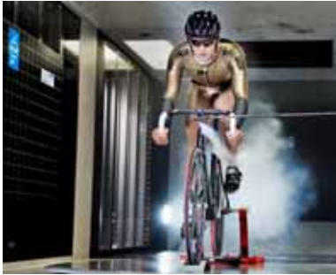
Figuur 19 – Bij wielrennen is de lucht-wrijving de belangrijkste factor, de rolwrijving is een stuk kleiner.
