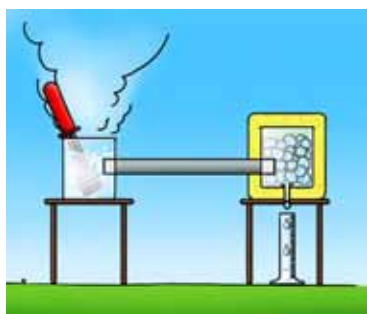
Figuur 5.6 Geleiding door een staaf
