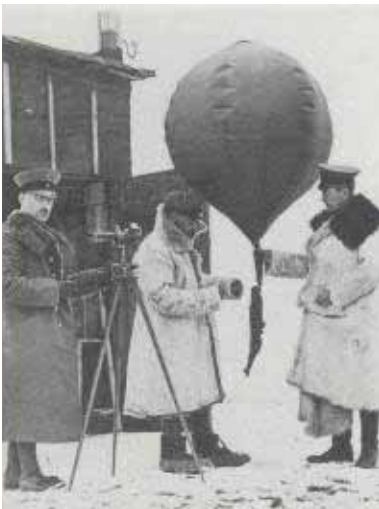
Figuur 57 – Duitse militairen uit de Eerste Wereldoorlog hangen ballast aan een met waterstof gevulde ballon voor ze hem laten opstijgen bij een weerstation aan het westelijk front. Uit de stijgingsrichting, die met behulp van een theodoliet (links) werd bepaald, bleek de snelheid en de richting van de wind.
