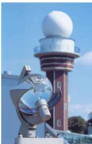
Figuur 4 – Bij het KNMI in De Bilt staat een neerslagradar boven op "de kopspijker". Op de voorgrond zie je een zonneshijnmeter waarmee het aantal uren zonneshijn wordt geregistreerd. Ook bij Den Helder staat op de vliegbasis een neerslagradar. Samen leveren de buienradars neerslagfilmpjes die je op vele websites en vaak in het journaal kunt zien.
