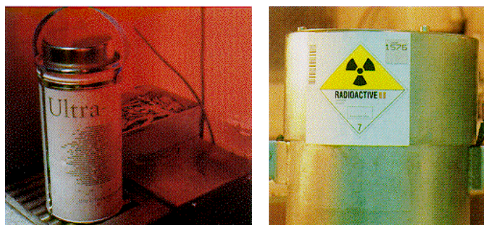
Figuur 2.17 In de afgeschermdde fles (foto links) bevindt zich molybdeen-99. Het molybdeen vervalt naar technetium-99m. Het 'verse' molybdeen-99 is goed voor de behandeling van zo'n tienduizend patiënten.
