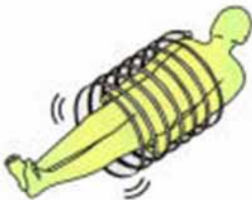
Figuur 4.16 Als de detectoren een schroeflijn om het lichaam trekken, wordt het mogelijk 3D opnamen te maken.
