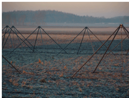
Figuur 102 – De LOFAR radiotelescoop bestaat uit een groot aantal relatief eenvoudige antennes die bijvoorbeeld in een weiland geplaatst kunnen worden (links). De LOFAR-antennes komen in een zeer groot gebied te staan (rechts).
